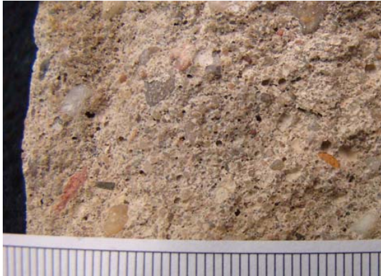
Abb. 12: Fragment einer Betondeckung; gut zu erkennen Wesersande und Buntkiese; augenscheinlich hohe Porosität und geringer Zementanteil
