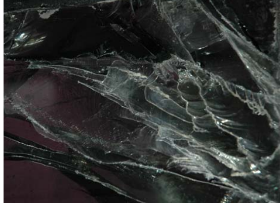
Abb. 15: innen; Detail der selben Stelle; vielschichtig ausgeprägtes Flinsen- und Sprungbild
