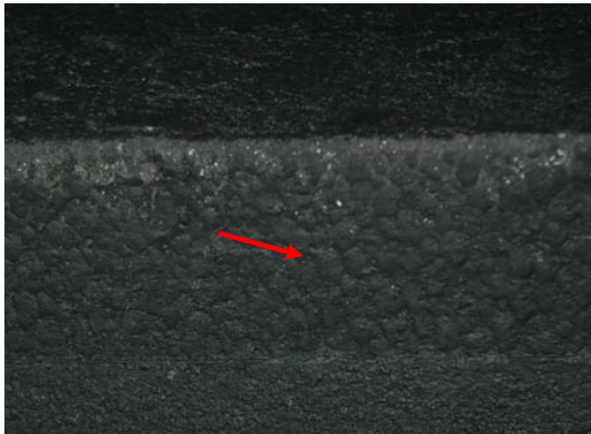
Abb. 4: innen; Abdrücke der Styroporoberflächen
